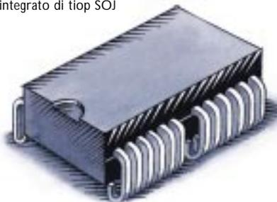
SOJ e TSOP sono componenti installabili sulla superficie del circuito stampato. TSOP e SOJ hanno guadagnato un posto preminente con l'avvento delle SIMM. Dei due, il formato SOJ è di gran lunga il più popolare.
