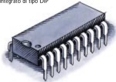
Il formato DIP era molto popolare fintantochè la memoria veniva installata direttamente sulla scheda madre del sistema. I chip di questo tipo sono componenti con reofori che vengono infilati in fori sul circuito stampato. Essi possono essere saldati oppure montati su zoccoli.
